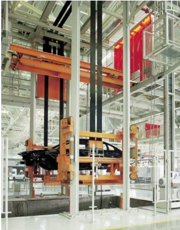
Figura 2 – Elevador industrial de carrocerias automotivas.
