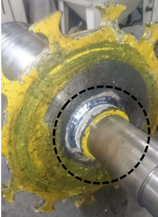
Figura 16 – Novo cordão de solda aplicado, região dianteira
