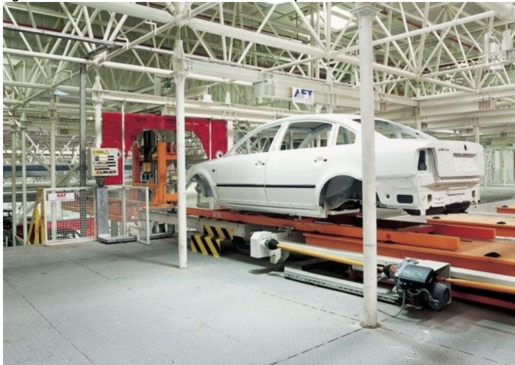
Figura 1 – Carroceria automotiva sobre skid em transporte
