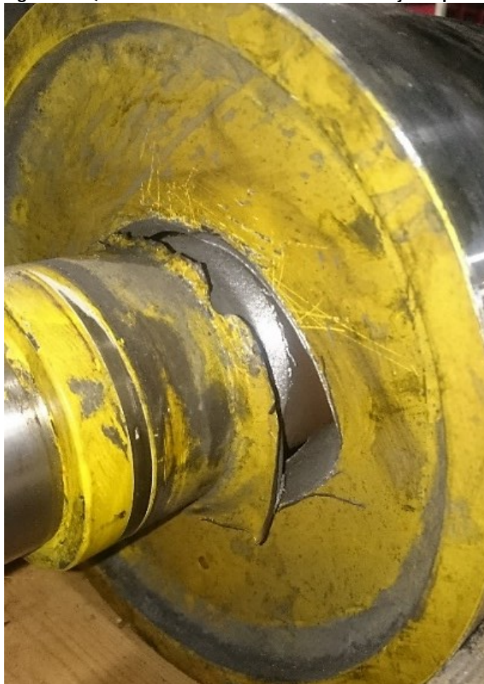
Figura 5 – Quebra de união soldada devido a esforços repetitivos
