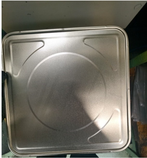
Figura 16 – Lata conformada depois da aplicação do lubrificante
