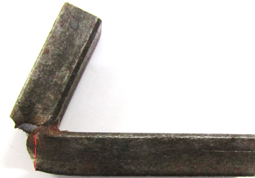
Figura 4 - (a) Corpo de Prova com Fratura Dúctil; (b) Corpo de Prova com Fratura Frágil
