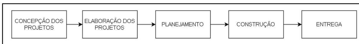
Figura 1 – Processo de construção de uma edificação
